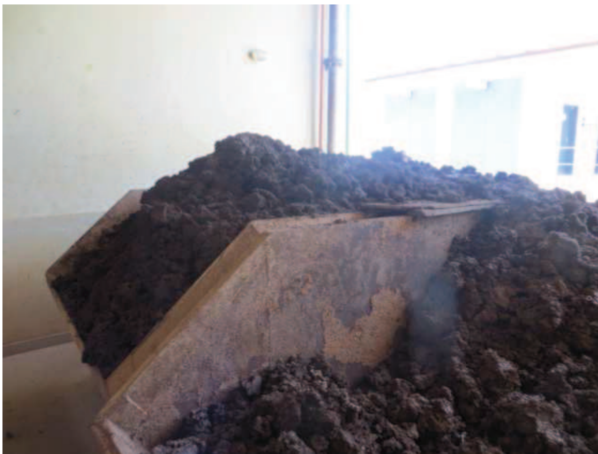
Figura 22 - Lodo centrifugado da ETA Porto das Caixas com teor de sólidos a 25%
